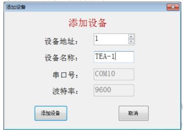
Device Addr 可以选择, Device Name 可以自定义。完成后点击 Add, 此时可以看到数型列表 Device List, 多出 TEA-1, 如下图所示
